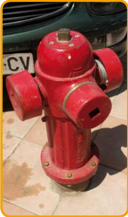
Los hidrantes son aparatos de donde se puede obtener agua. Se utilizan para llenar las cisternas de los camiones de los bomberos o para enchufar las mangueras cuando hay que apagar un incendio cercano.
